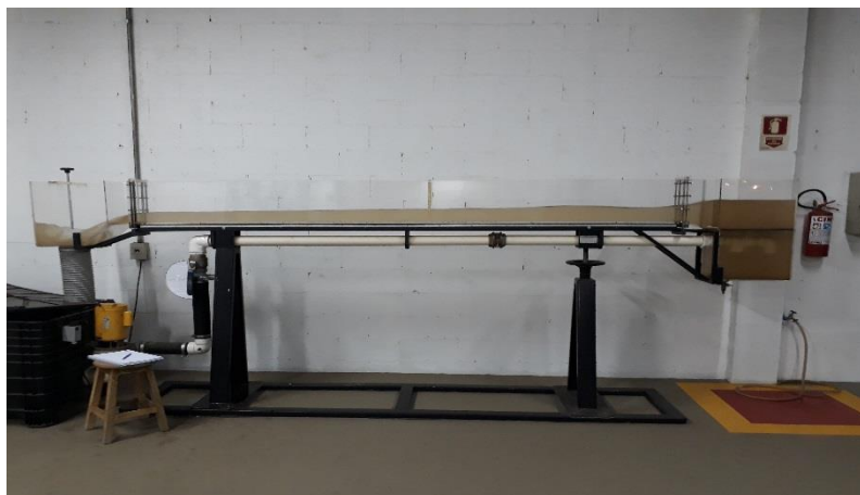
Figura 1 Vista frontal da bancada didática para experimento em canais de escoamento em carga. (Fonte: Arquivo Pessoal, 2017)
